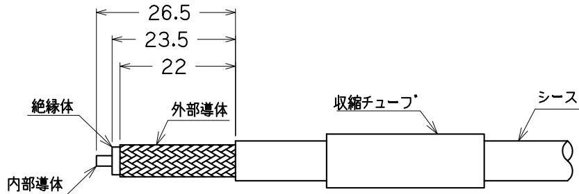
シェルに取り付いている止めネジ<sup>\*</sup>を外して、同軸ケーブルへ
