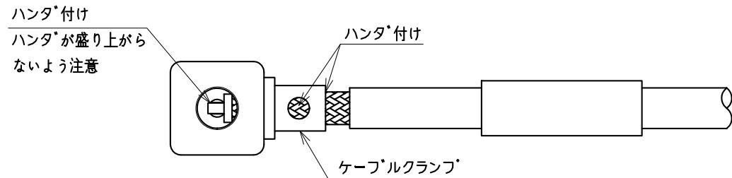
中心コントクトと内部導体に対してハンダ<sup>\*</sup>付けをして、一度手で
