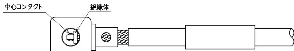
加工した同軸ケーブルにシェルを取り付ける。この時内部導体が
